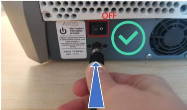
Figure 1 : Branchement du bloc d'alimentation lorsque l'interrupteur est à la position « Arrêt » / « Off ».
