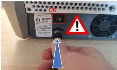
Figure 2 : Attention à ne pas brancher le bloc d'alimentation lorsque l'interrupteur est à la position « Marche » / « On »
